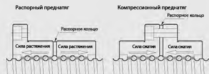
Рис 4.17 Преднатяг установленный с помощью распорного кольца
