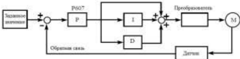
При использовании PI или PID – законов регулирования допускается возможность возникновения ошибки регулирования с величиной до  $\pm 10\%$  от значения максимального сигнала обратной связи.
