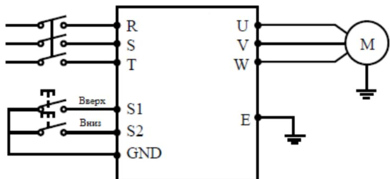
Параметр: P317=15, функция ВВЕРХ назначена на терминал S1; P101=4, способ установки частоты - способ вверх/вниз; F318=16, функция ВНИЗ назначена на терминал S2.
