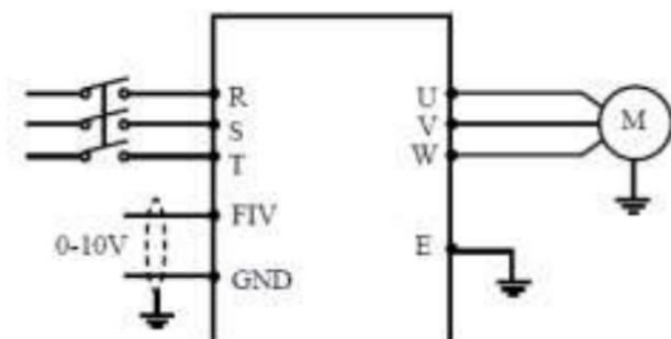
Примечание: 0-10V сигнал непосредственно введен через FIV, чтобы управлять рабочей частотой преобразователя частоты.
