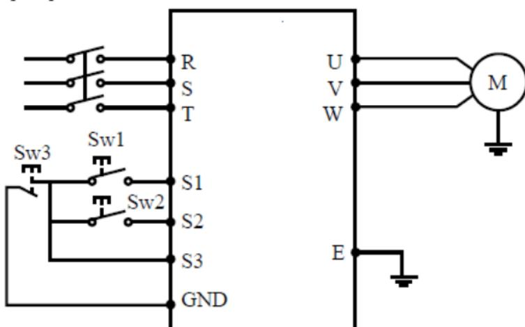
В качестве входов для внешнего сигнала здесь используются Sw1, Sw2, и Sw3. Контакт Sw3 нормально замкнутый. S1, S2 и S3 отобраны как входные терминалы для внешнего сигнала. Параметр: P317=6, прямое управление назначено на S1 P318=7, обратное управление назначено на S2 P319=8, останов, назначен на S3 P102=1, управление через внешние терминалы
