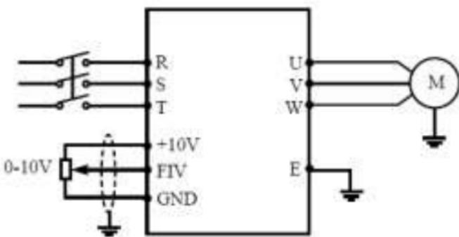
Примечание: сигнал напряжения FIV введен через внешний потенциометр ( $10\text{ k}\Omega$ ), чтобы управлять рабочей частотой преобразователя частоты.
